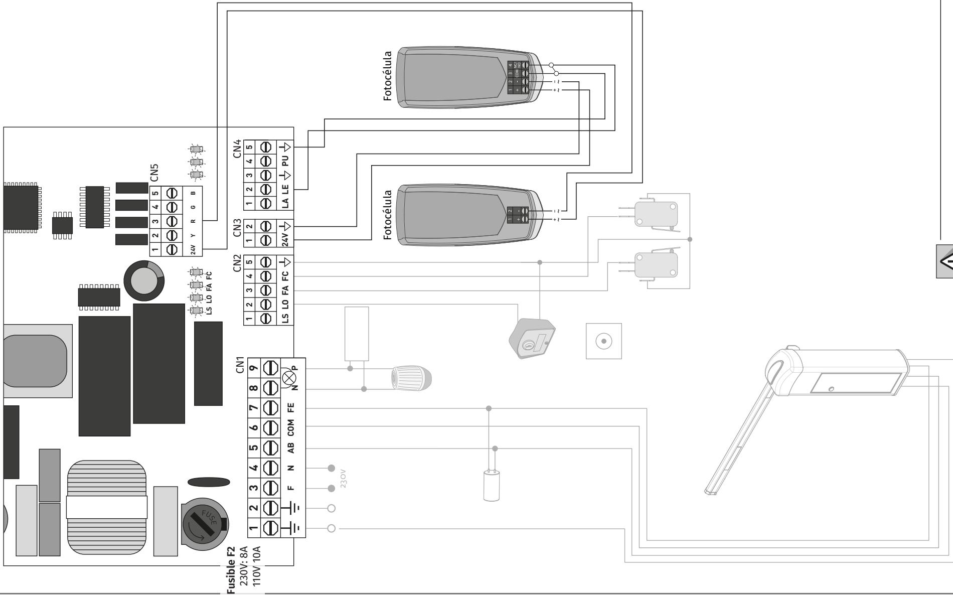
Con el Test de las fotocélulas activo, la alimentación de las fotocélulas se realiza desde el conector CN5 en las entradas **24V(+)** y **R(-)**.
